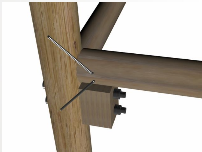
木构架节点加固连接示意
