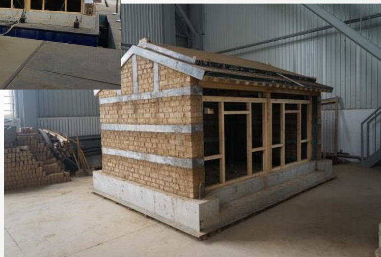
配筋砂浆带加固生土墙体模拟地震振动台试验（模型）
