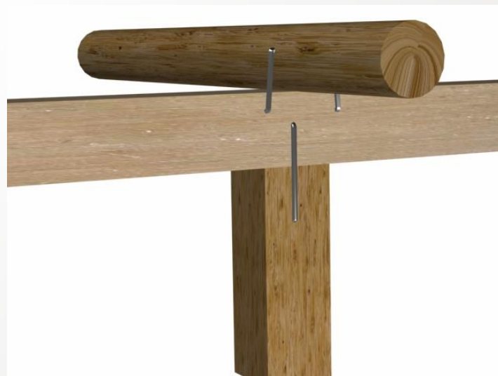
木构架节点加固连接示意
