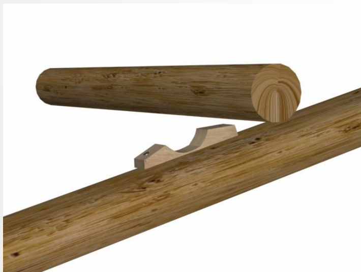
木构架节点加固连接示意
