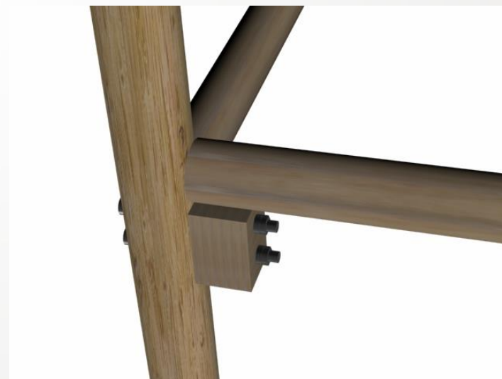
木构架节点加固连接示意
