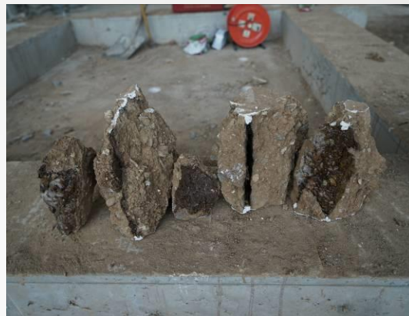
注浆修补裂缝，拆除墙体时修补处粘结良好
